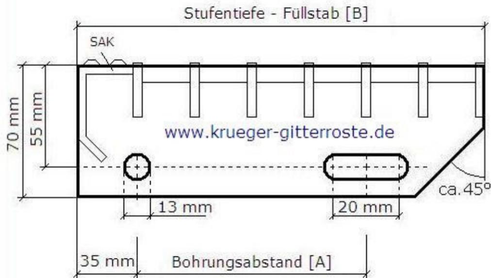
Durch Sicherheitsantrittskante geprüft mit BG R12, die Trag- und Füllstäbe müssen keine zusätzliche Profilierung haben!
