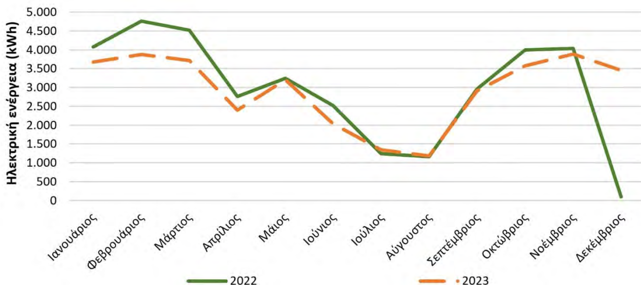
Σχήμα 2: Ετήσια διακύμανση ενεργής κατανάλωσης ηλεκτρικής ενέργειας στην υφιστάμενη κατάσταση λειτουργίας στο 2 ο Γυμνάσιο – Λύκειο Ρεθύμνου.
