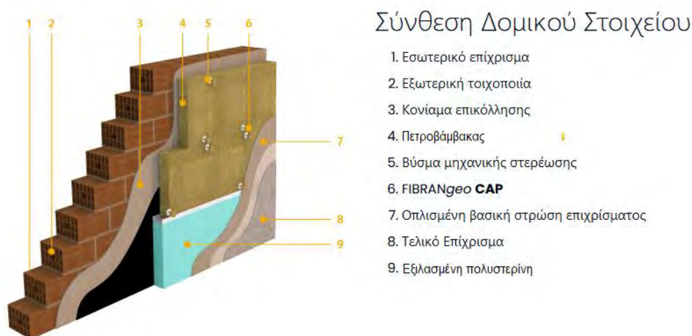
Σχήμα 33: Διάταξη εξωτερικής θερμομόνωσης τοιχοποιίας.
