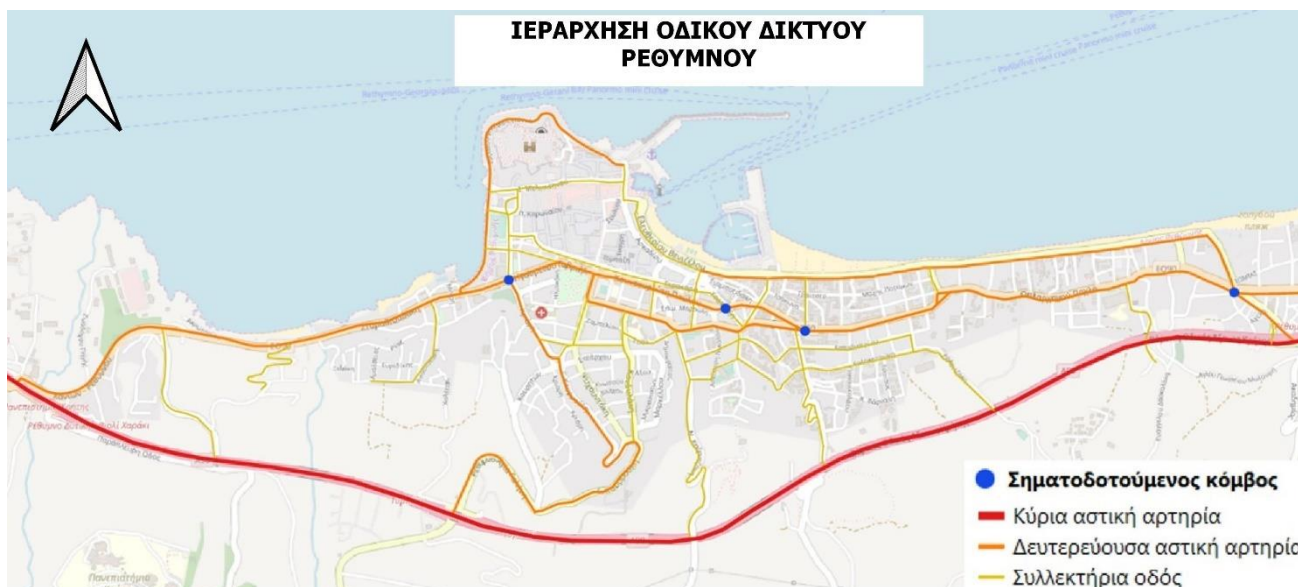
Εικόνα 3-4: Ιεράρχηση οδικού δικτύου στο Ρέθυμνο
